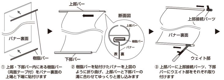
① 上部・下部バー内にある樹脂バー（両面テープ付）をバナー裏面の上端と下端に貼付けてください
